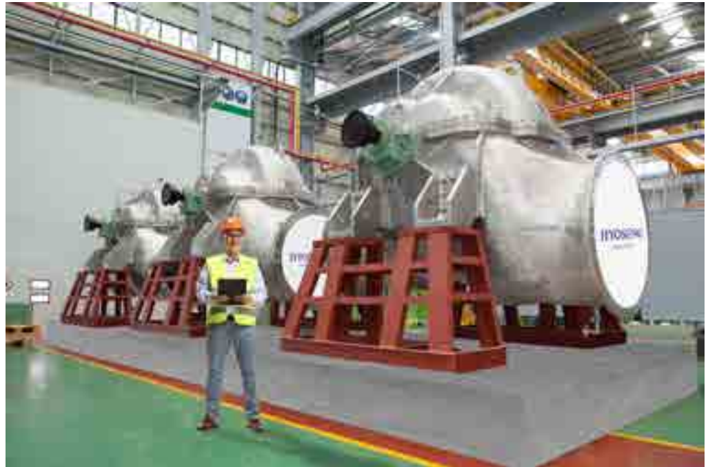
Modelo HDR: Para flujos de 43.000 m 3 /h y 550 mts. Ideales para aplicaciones en Agua de Mar y Oil & Gas.
